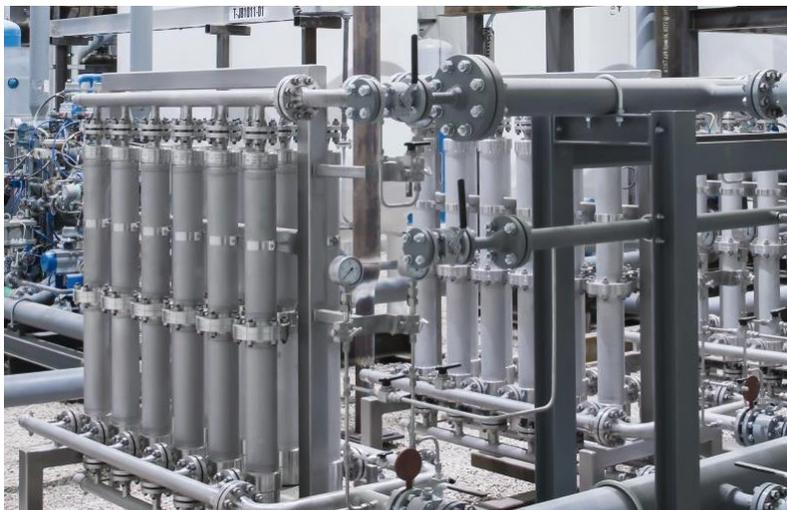
**Bildunterschrift:** Das Bild zeigt Membranen – ein Teil der Anlage zur Heliumaufbereitung in Mankota, Kanada. (Quelle: The Linde Group).
