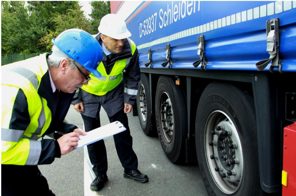
**Bild:** Die Bereifung wird bei der Kontrolle genauso in Augenschein genommen wie der allgemeine Fahrzeugzustand und die Ladungssicherung.
